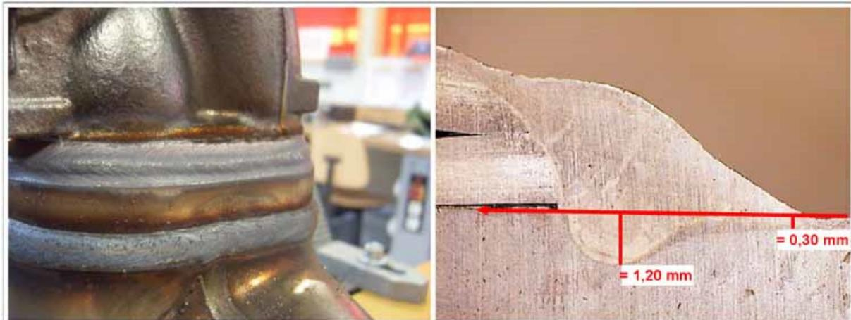
2: Der Makroschliff einer Dreiblechverbindung eines Turboladergehäuses am Krümmer zeigt augenfällig die einwandfreie Qualität der Schweißnaht und -verbindung.
