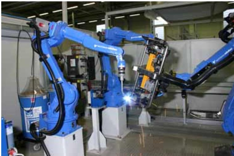
2: Für die Anwender des Power Joint lite bei Robotern mit integrierten Brennerkabeln und Medienführungen entfällt die Torsionsbelastung der Zuführungen zum Brenner; Standzeit und Lebensdauer steigen.
