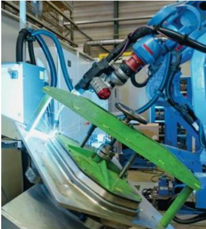
1: In höchster Präzision fördert der Frontpull 7 auch „schwierige“ Schweißdrähte beim automatisierten Lichtbogenschweißen und -löten.
